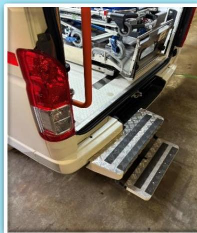
救急車へ同乗いただく方の乗り降りに、より高い安全性を求め、電動ステップを初めて搭載しました。
