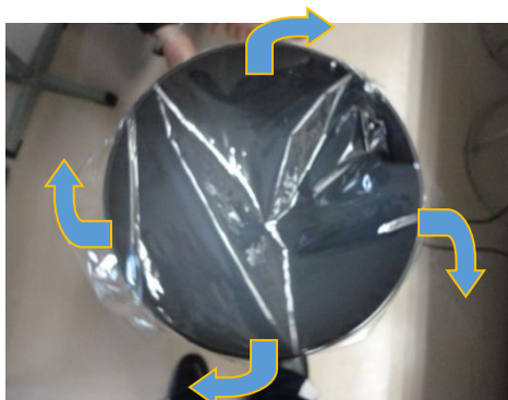
ゴミ箱に穴をあけて、スモーク（ドライアイスと水など）を入れ反時計回りに回転 【高気圧から吹き出す風】
