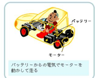
電気自動車の仕組み
