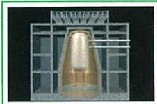
建屋の屋根を鋼材で補強
