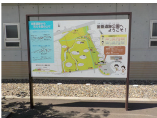
写真5-1. 釜蓋遺跡 (上越市) 駐車場の案内図。金属フレームにアルミ複合版の盤面、シルク印刷。H 1.8 m、盤面 1.8 × 1.2 m
