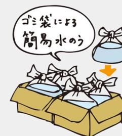
40リットル程度の容量のゴミ袋を二重にして、中に半分程度の水を入れて閉めます。これをダンボール箱に入れ、連結して使用します。
